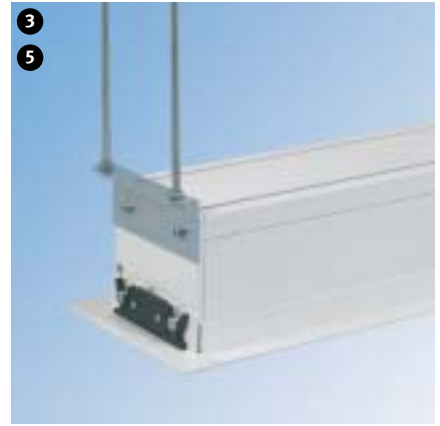
3 5 Einbaurahmen mit Montageset für abgehängte Decken. Seitliche „Clip-Winkel“ können zu Revisionszwecken entfernt werden.
